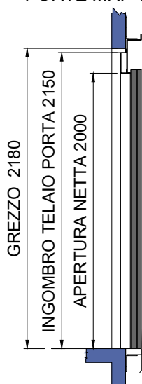
SEZIONE TELAI PORTE NF (EI120)
