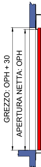
SEZIONE TELAIIO PORTE NF (EI120)
