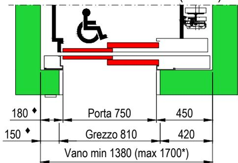
\* E' POSSIBILE AUMENTARE LE DIMENSIONI DEL VANO FINO AI VALORI MASSIMI INDICATI. PER VANI CON DIMENSIONI COMPRESSE TRA I VALORI MINIMI E MASSIMI, AUMENTARE TUTTE LE QUOTE INDICATE CON ♦ DELLA DIFFERENZA CON IL VALORE MINIMO. LA DIMENSIONE DELLA TESTATA È GARANTITA PER VANI CON DIMENSIONI COMPRESSE TRA I VALORI MINIMI E MASSIMI. PER VANI CON DIMENSIONI MAGGIORI CONTATTARE LA DITTA PRODUTTRICE.
